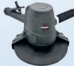
ST-7789 9" Ağır hizmet dikey taşlama Yandan egzozlu Hız: 6,500 rpm Çıkış mili: M16x2.0
