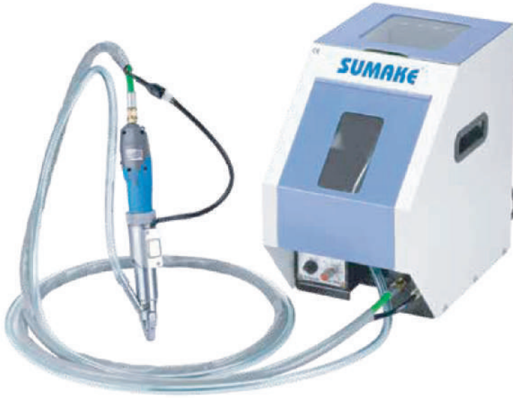
SF30A (Bastırmalı push-start) Otomatik Vida Besleme
