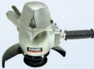
ST-7784 9" Hız: 5,900 rpm ST-77847 7" Hız: 7,000 rpm ST-77845 5" Hız: 12,000 rpm Ağır hizmet dikey taşlama Çıkış mili: 5/8"-11
